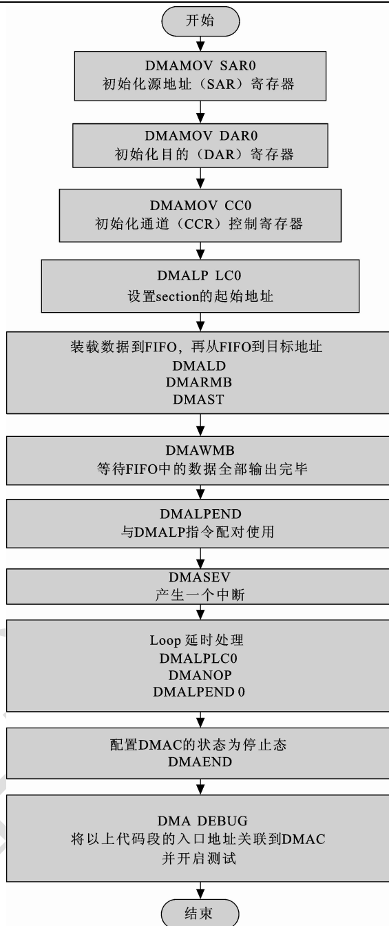
图 16-24 DMAC 控制流程
